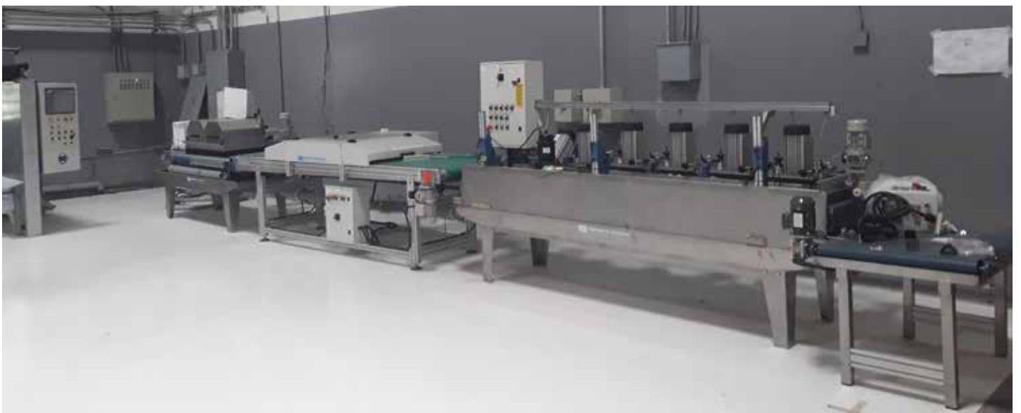
COMPACTLINE2 Linea automatica per taglio e profilatura Automatic cutting and edging-profiling line Línea automática para el corte y canto romo Ligne automatique pour la coupe et le façonnage
